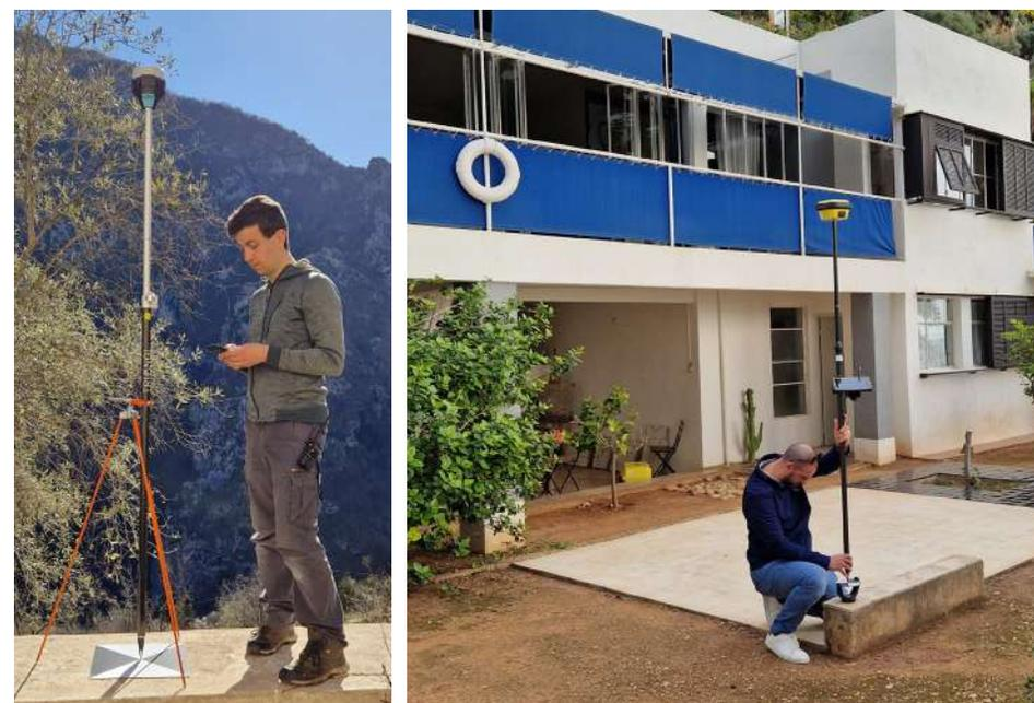
Mesure d'une position de géoréférencement avec une antenne GNSS (géolocalisation et navigation par un système de satellites), monastère de Saorge et site de Cap Moderne © CMN
