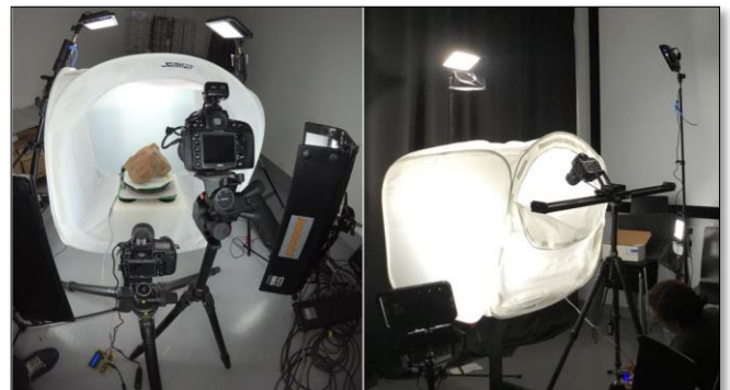
Figure 8 - Exemples d'installations de numérisation 3D par photogrammétrie avec une table tournante (MAP – UMR 3495)
